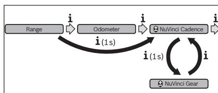
V režime <Gear Control (Riadenie rýchlosťi)> môžete tlačidlami –, príp. + na ovládacej jednotke prepínať medzi viacerými definovanými prevodmi nahor alebo nadol. Aktuálny prevodový stupeň sa vám zobrazí na displeji.
